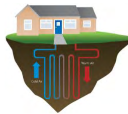
Geothermal Cooling system מקור - Wheel Jane
